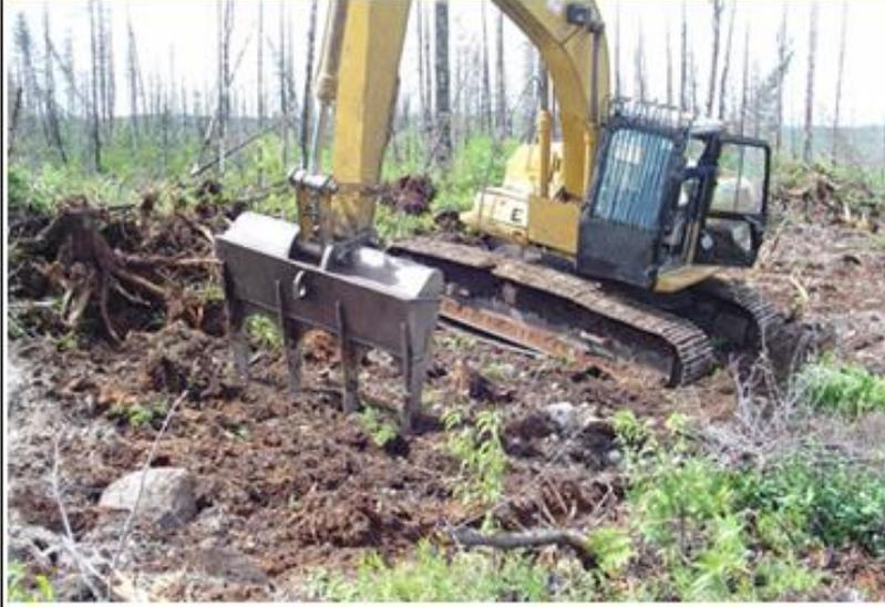
Ce scarifiage consiste à brasser la couche de sol organique et les débris ligneux à l'aide d'une pelle excavatrice munie d'un peigne.
